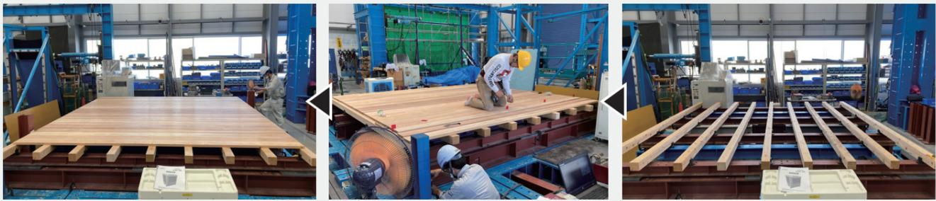
写真11 弾性剣道場床を財建材試験センターにて試験 (JISA6519) した時の様子
